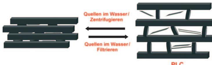
Zuge eines Übergangs zwischen geordneter und ungeordneter Form, der durch eine mechanische Kraft bewirkt wird (siehe Bild). Diese flexible Porosität wurde genutzt, um Farbstoffmoleküle anhand ihrer Größe zu trennen.
